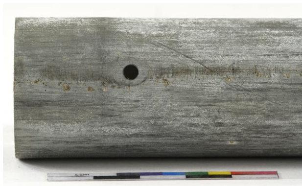
Figure 39 Altérations à l'interface anode-planche de l'anode 2C15 ©HE-Arc, 202
