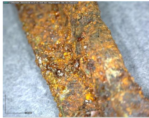
Figure 59 Produits de corrosion orange à noir sur une plaquette informative ©HE-Arc, 2023
