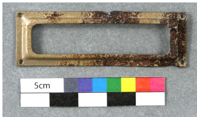
Figure 87 Arrière de la plaquette métallique après ajout de résine acrylique paraloïd B72 à 10% dans l'isopropanol et cire microcristalline ©HE-Arc, 2023
