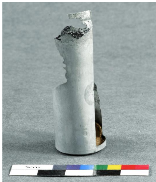
Figure 260 Anode après bain de Shelsoll T® avec huile de neem ©HE-Arc, 2023
