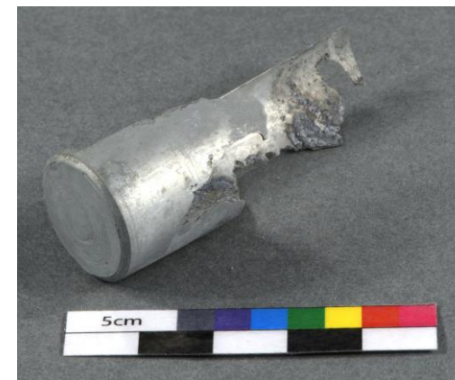
Figure 257 Anode après bain d'EDTA et second bain de sesquicarbonate de sodium ©HE-Arc, 2023
