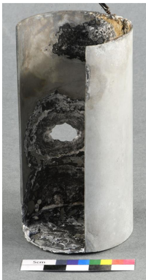
Figure 92 Anode de l'élément 2C30, après traitement par bain d'EDTA et retrait de produits de corrosion au scalpel. Interventions incomplètes ©HE-Arc, 2023
