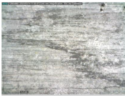
Figure 222 Echantillons R2, produits blancs et noirs de l'anode 2C20 analysés ©HE-Arc, 2023
