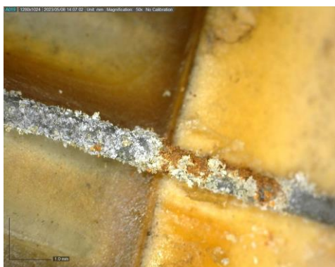
Figure 54 Fil d'attache en acier zingué ©HE-Arc, 2023
