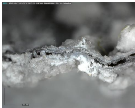
Figure 44 Vue en coupe d'une anode en zinc très dégradée ©HE-Arc, 2023
