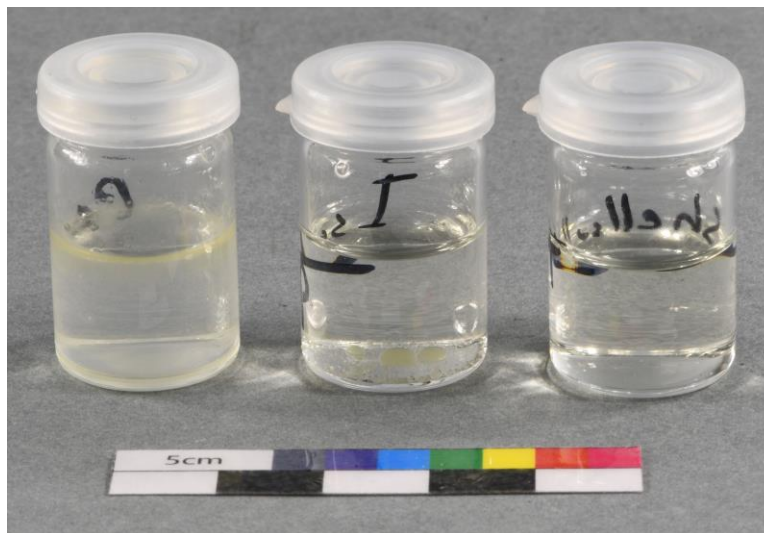
Figure 258 tests de solubilité de Neem, de gauche à droite : eau démin., isopropanol, Shellsol T®@HE-Arc, 2023
