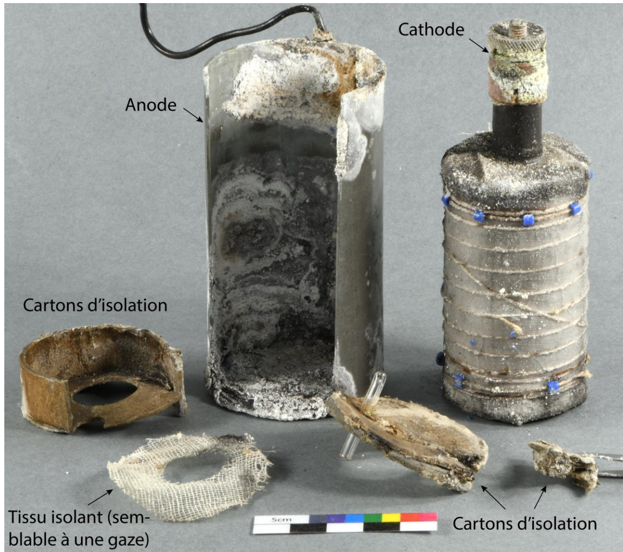
Figure 90 Pile 2C30 démontée pour traitement ©HE-Arc, 2023
