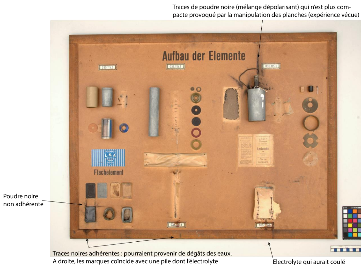
Figure 27 Traces de coulures et de fuites sur l'avant de la planche 2-C ©HE-Arc, 2023
