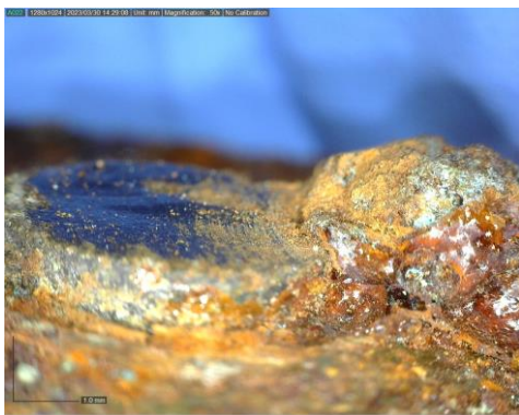
Figure 104 Haut de la tige de carbone, calotte en laiton complètement corrodée ©HE-Arc, 2023
