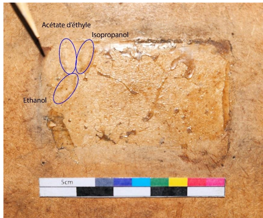
Figure 229 Tests de solubilité sur les restes d'adhésif, emplacement de l'élément 2C12 ©Stiftung HAM, 2023
