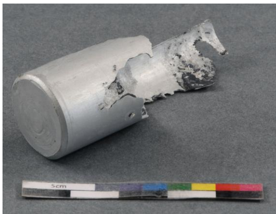
Figure 256 Anode après traitement en bain d'EDTA ©HE-Arc, 2023
