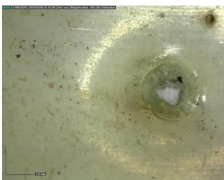
Figure 71 Avant tests de retrait de produits de corrosion ©HE-Arc, 2023
