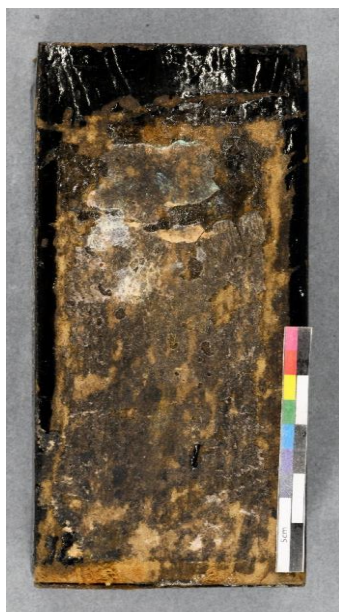
Figure 97 Face arrière du carton bitumé : avant retrait d'un ancien adhésif ©HE-Arc, 2023
