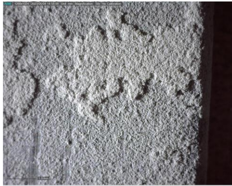
Figure 223 Echantillon R4, produits de corrosion blancs obtenus sur le coupon I.II ©HE-Arc, 2023
