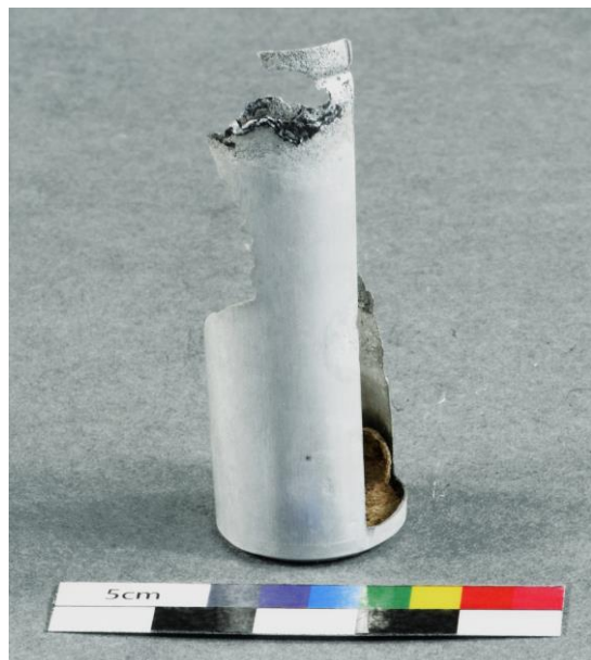
Figure 259 Anode avant bain de stabilisation par inhibiteur de corrosion ©HE-Arc, 2023
