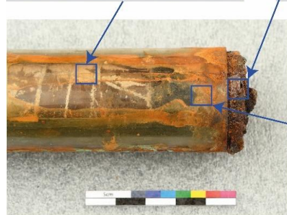
Figure 159 Description des altérations de l'élément 2C25, partie I ©HE-Arc, 2023
