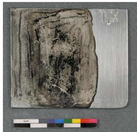
Figure 47 Coupon I.X pendant vieillissement par un électrolyte de chlorure de zinc et de chlorure d'ammonium ©HE-Arc, 2023
