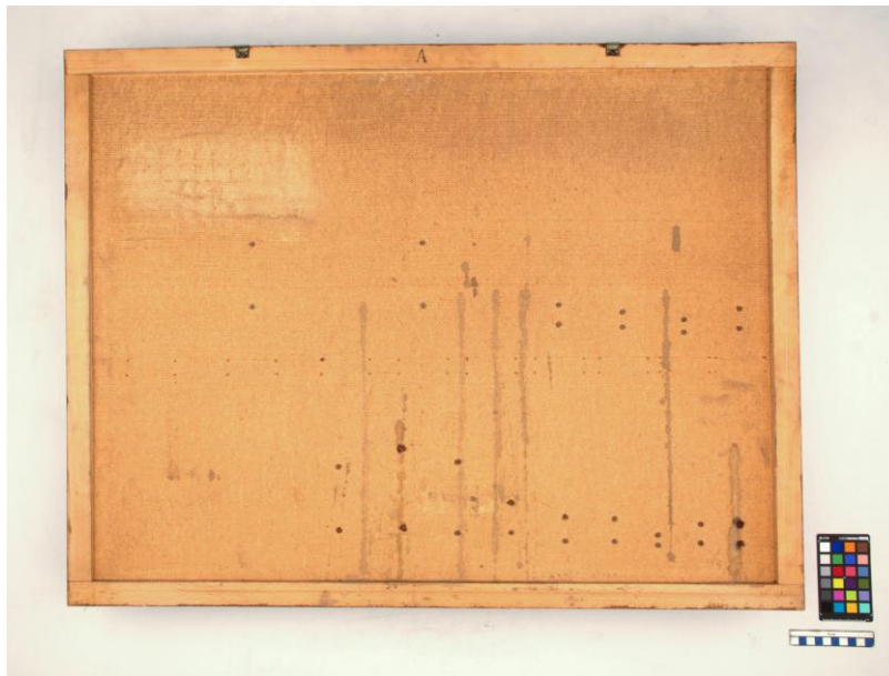
Figure 28 Traces de coulures à l'arrière de la planche 3-A ©HE-Arc, 2023
