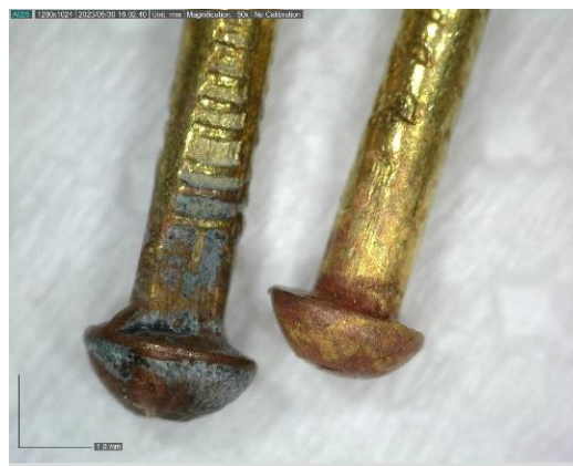
Figure 74 A droite, clou traité en bain d'EDTA à pH9. A gauche, clou traité en bain d'EDTA à pH6 ©HE-Arc, 2023
