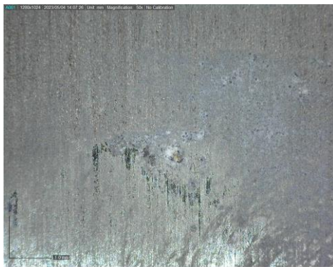
Figure 224 Echantillon R5, produits de corrosion obtenus sur le coupon II.IV ©HE-Arc, 2023
