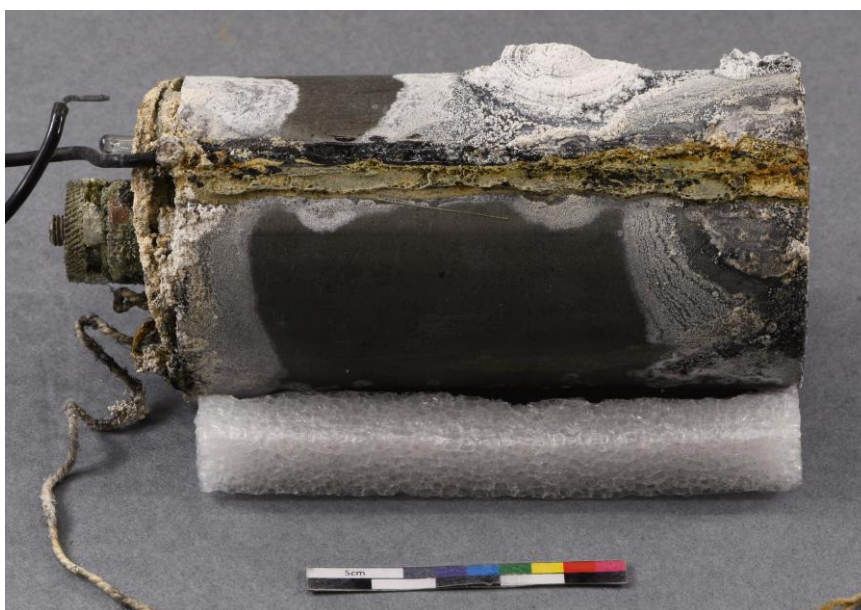
Figure 41 Arrière de la pile de campagne 2C30 ©HE-Arc, 2023
