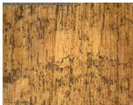
Figure 61 Baguette en bois, après retrait à la gomme ©HE-Arc, 2023
