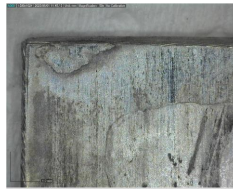
Figure 254 Coupon I.X après test de traitement par compresse d'EDTA pH9 ©HE-Arc, 2023
