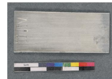
3ème Bain : Sesquicarbonate de sodium, pH9
