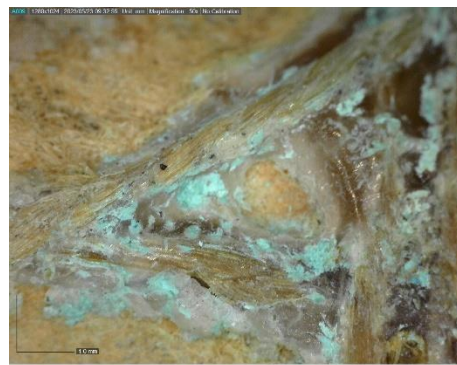
Figure 78 Après nettoyage partiel au gel d'EDTA ©HE-Arc, 2023
