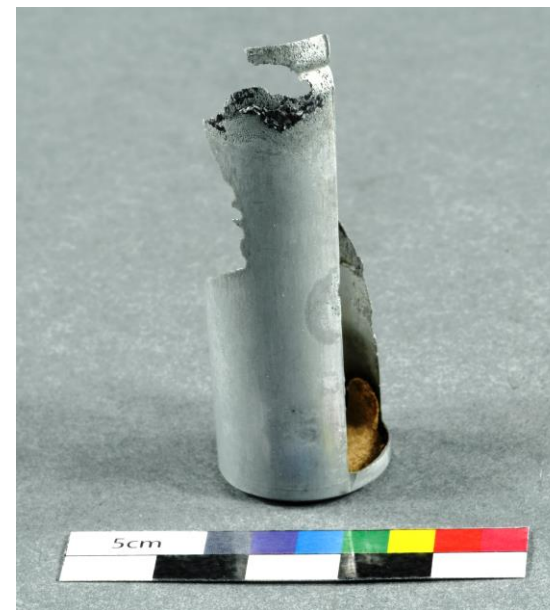
Figure 261 Anode après ajout d'une résine acrylique Paraloid B72 à 10% ©HE-Arc, 2023
