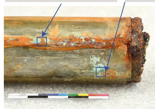
Figure 160 Description des altérations de l'élément 2C25, partie II ©HE-Arc, 2023
