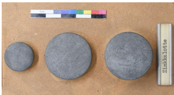
Figure 21 Calottes en zinc de dimensions différentes ©HE-Arc, 2023
